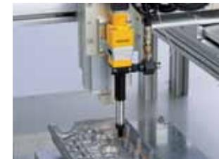
ロボディスペンサーとロボットを同時に制御することにより、作業中に吐出量・スピード・時間 등을変える等の複雑な動作も容易です。複雑な形状のワーク・容器でもより均一な塗布・高精度な充填が可能です。
