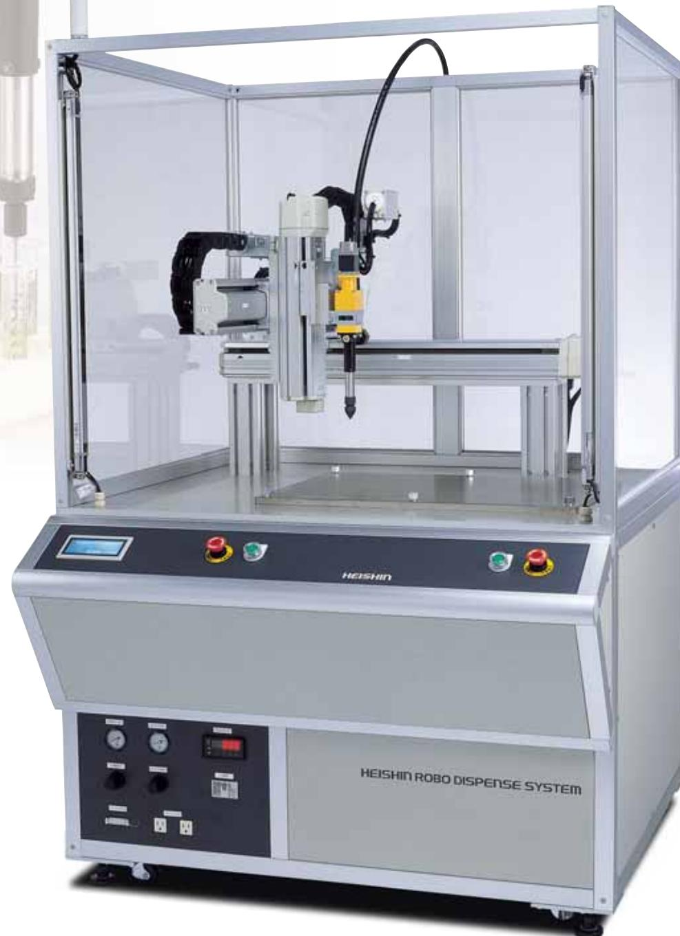
ロボット軸と作業エリアの平行度を厳密に設定しているので、安定した塗布・充填作業が可能です。
