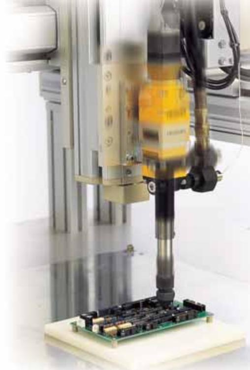
複数種のワーク・容器に対しても個別の塗布・充填パターンを記憶させておけば、コントロールパネルの操作だけで選択・変更できるので、段取り時間を短縮できます。
