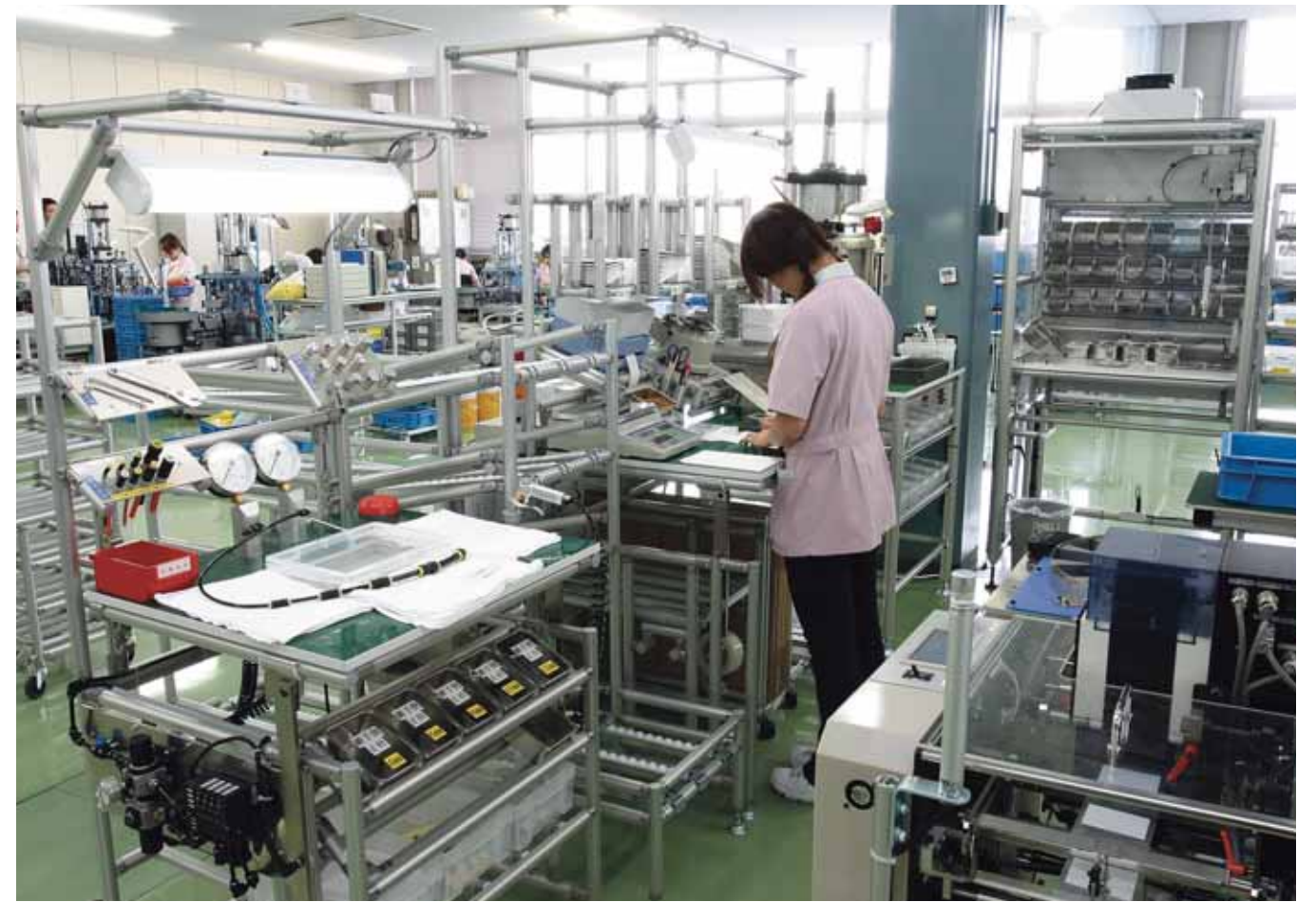
工程毎に作業台がレイアウトされています。通常の作業は1人体制ですが、生産量が増えた際には作業台を分割して複数で作業できるように設計されています。
