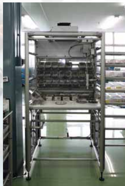
クリーンベンチ作業台。天井についているクリーンファンは、SUS株のクリーンファンユニットを採用したものです。
