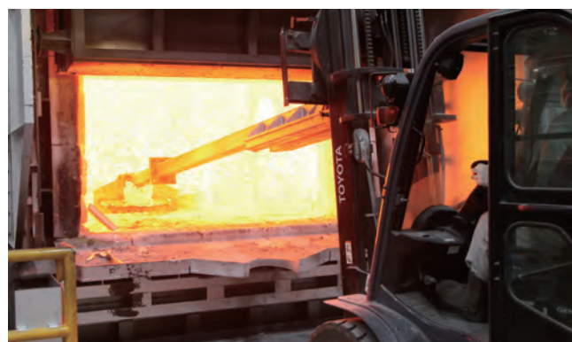
アルミフレームを溶かし、ピレットとして再生する福島事業所の铸造炉。
