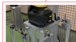
ダイヤルゲージでスタンドのずれを確認し、繰り返し動作による精度を検証。
