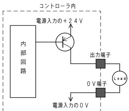
本出力素子は、負荷短絡もしくは定格以上の電流が流れた場合は、内部回路が破損します。
