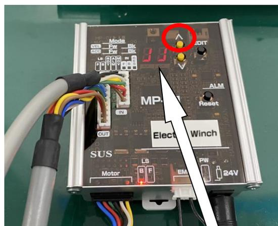
上下スイッチの下ボタンを長押しで下降LS ONまで動作します。
