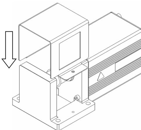
⑨左右のカバー取付ネジを締めて、カバーを固定します。
