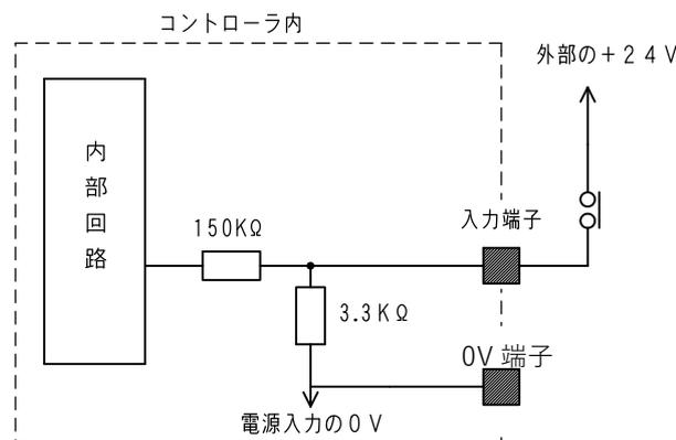
外部に無接点回路を接続される場合、スイッチOFF時の1点当たりの漏洩電流は1mA以下として下さい。
