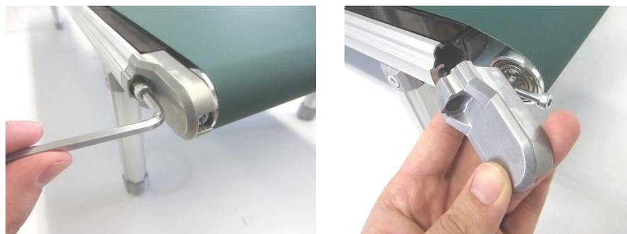
テンション調整ローラを保持しているローラホルダのうち、モータと反対側のローラホルダを外してください。
