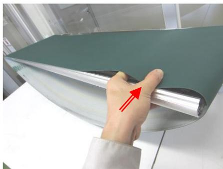
ベルトの表裏を確認し、外した時と逆の手順でベルトを取付けてください。
