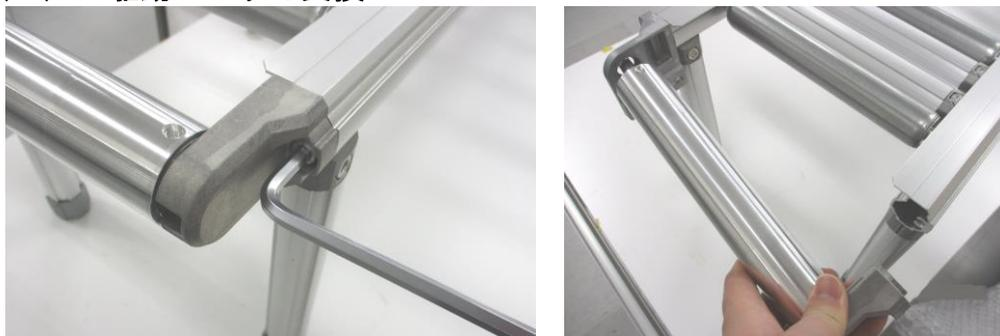
駆動ローラを保持しているローラホルダを外し、駆動ローラを抜き取り、新しい駆動ローラを逆の手順で取り付けて下さい。
