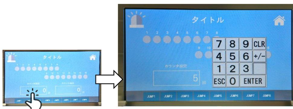
タッチパネルの「カウンタ設定」をタッチすると、「TP.COUNTER1」の値を指定できます。「5」を指定した際は、ID.1\_IN1 が「5回」カウントすると G-FLAG1 が ON します。設定した値は「カウント表示」に表示されます。
