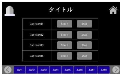
稼働・停止操作画面 (4 個)
