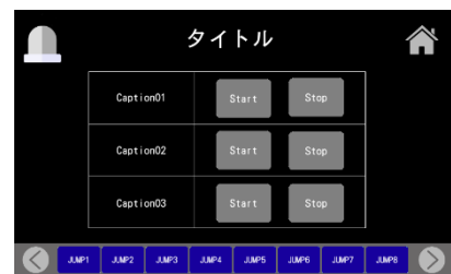
稼働・停止操作画面 (3 個)
