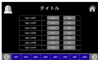
稼働・停止操作画面 (7 個)
