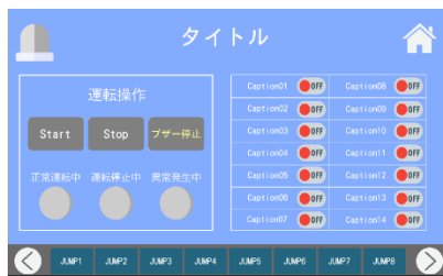
運転操作画面(スイッチ 14)
