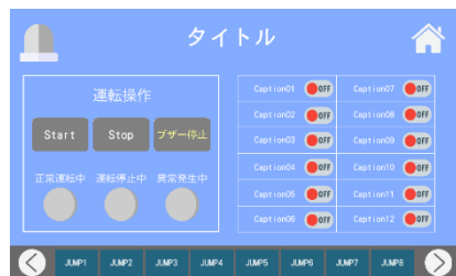
運転操作画面(スイッチ 12)
