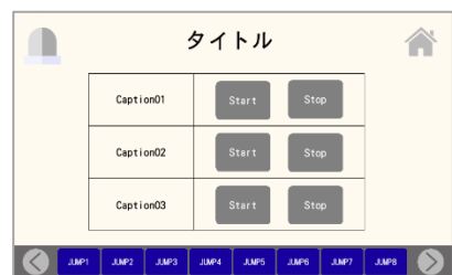
稼働・停止操作画面 (3 個)
