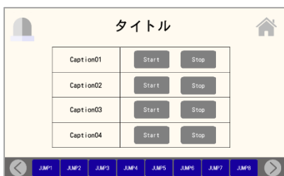
稼働・停止操作画面 (4 個)
