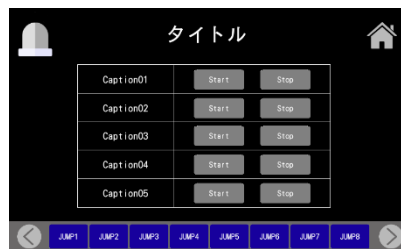
稼働・停止操作画面 (5 個)
