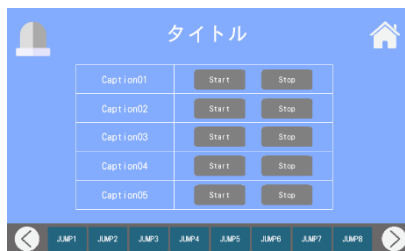
稼働・停止操作画面 (5 個)
