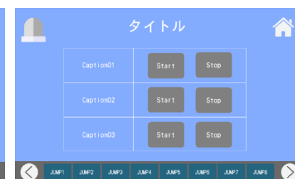
稼働・停止操作画面 (3 個)
