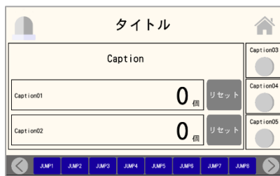
稼働モニタ画面 (カウンタ 2 個, リセットボタン付き)
