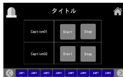
稼働・停止操作画面 (2 個)
