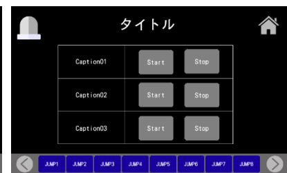
稼働・停止操作画面 (3 個)
