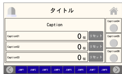
稼働モニタ画面 (カウンタ 3 個, リセットボタン付き)
