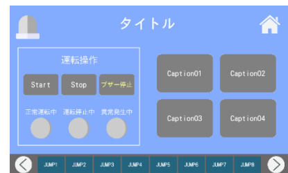
運転操作画面(ボタン 4)
