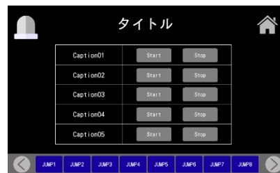
稼働・停止操作画面 (5 個)
