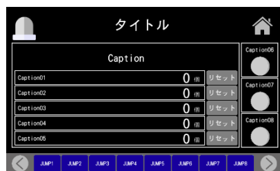
稼働モニタ画面 (カウンタ 5 個, リセットボタン付き)
