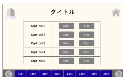
稼働・停止操作画面 （5個）
