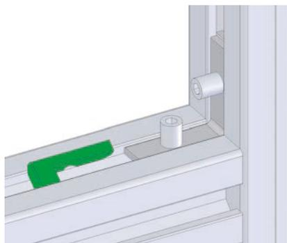
本体部を先に締結部へ挿入し、後からキー部を挿入、本体と一体にする。
