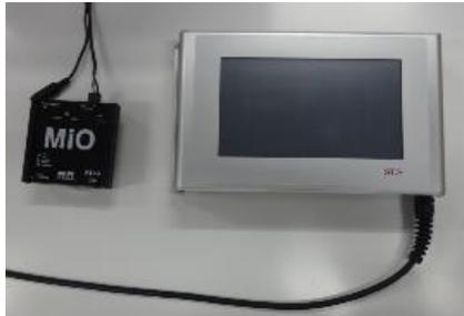
2. MiOタッチパネル電源コネクタ、MiOコントローラに電源を接続し、電源ON
