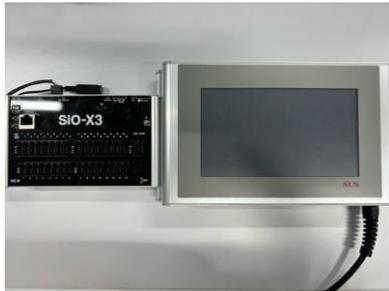
2. SiO-Xタッチパネル電源コネクタ、SiO-Xコントローラに電源を接続し、電源ON
