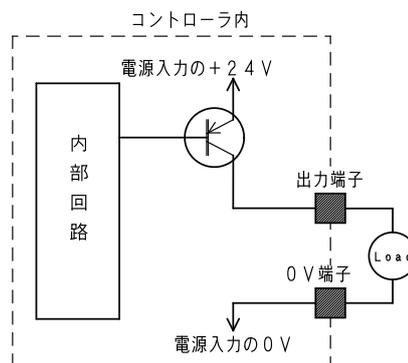
本出力素子は、負荷短絡もしくは定格以上の電流が流れた場合は、内部回路が破損します。
