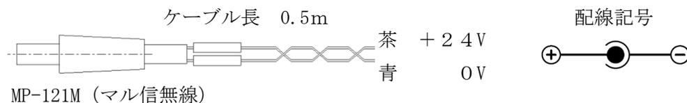
電源を逆接続されますとコントローラが破損します。
