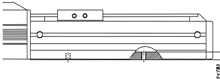
取り付けはボルトで本体を締め上げて固定します。その際に表記したタップ深さに合うボルト長さを選定し、または座金等で調整して取り付けして下さい。
