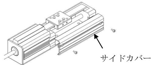
②サイドカバーの溝に M2 六角ナットを挿入し、
