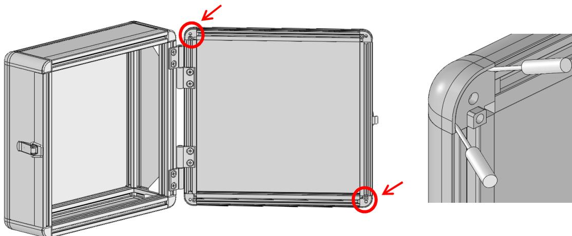
②赤線部のネジを外してL字のままフレームを引き抜いてください。(対角2カ所／計2本)
