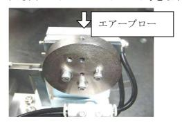
③先端ワーク検出センサを取り付け、センサの検出確認をして下さい。
