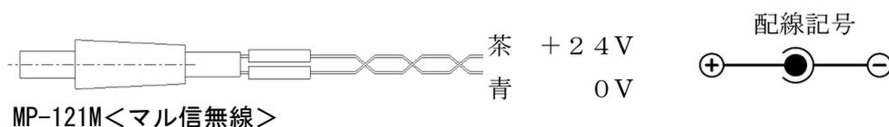
電源を逆接続されますとコントローラが破損します。
