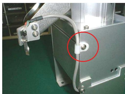
③ モータベースを固定している M3 六角穴付ボルトを取り外します。
