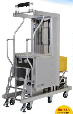
仕様 全長 1,650mm 本体サイズ 幅 600mm 1,910mm 作業床高さ 1,000~1,950mm 作業床 100kg 可搬重量 昇降荷台 150mm/sec 上昇速度 バッテリー 使用時間めやす 約11時間 (EV用制御弁式鉛蓄電池12Vx2個) モータ DCブラシレスモータ 24V 400W キャスター φ130 フットブレーキ別付
