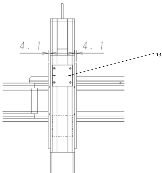
X 軸・Y 軸・Z 軸にカバーを取り付けてください。
