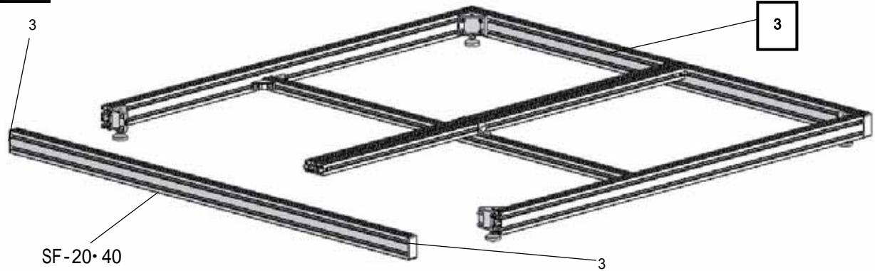
フレーム上面には先にナットを挿入しながら組み立てます。
