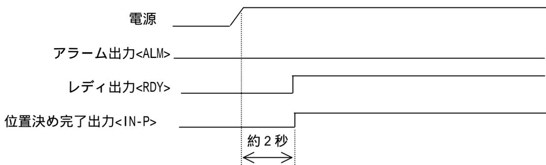
電源投入約 2 秒後に、位置決め完了出力<IN-P>が ON します。
