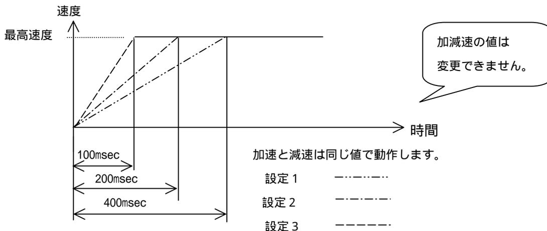
速度と加速・減速時間は比例しているため、設定された速度が最高速度の半分であれば加速・減速時間も半分に、1/10 ならば加速・減速時間も 1/10 になります。
