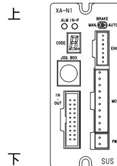
取り付けは鉄板、アルミ板等の熱伝導の良い物にしっかりとネジ止めしてください。
