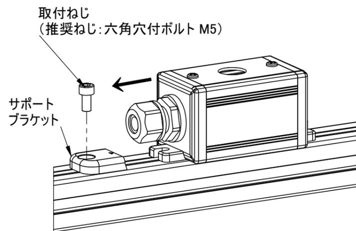
取付ねじ(六角穴付ボルト、トラスねじなど) M5
