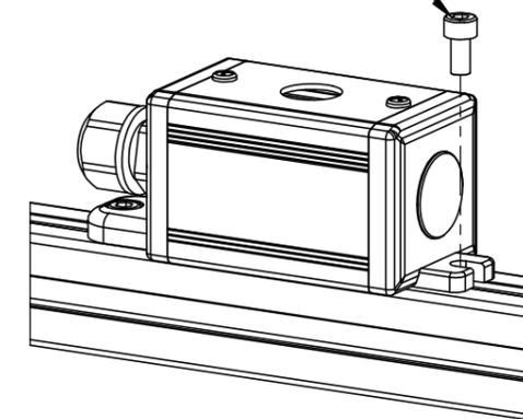
従来タイプでケーブルの取り出し口が邪魔をしてレンチが入りにくかった部分を改良しました。付属のサポートブラケットを使えば差したり抜いたり簡単に取り付け、取り外しが可能。
